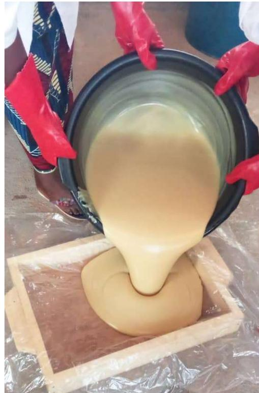
Nach der Mischung und Einfüllung in Seifenformen, werden die Seifen nach einer Weile aus den Formen herausgeholt und mit Hilfe des Schneidetisches in Würfel geschnitten. Anschließend wird mit dem Stempelgerät das Siegel der Kooperative darauf gestempelt.
