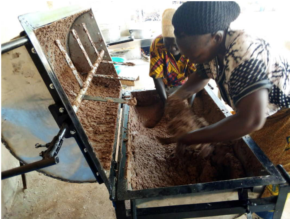
Abbildung 8: Die gewonnene Shea-Paste wird nun durch den Mixer vermengt damit die Sheabutter aus der Masse getrennt werden kann.
